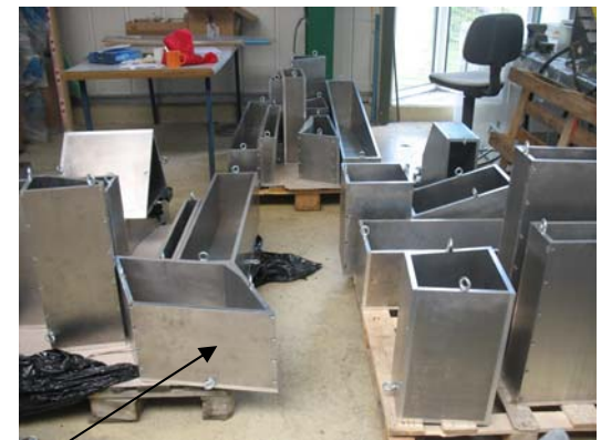
Moulds for the pour of the Vyal-B resin
