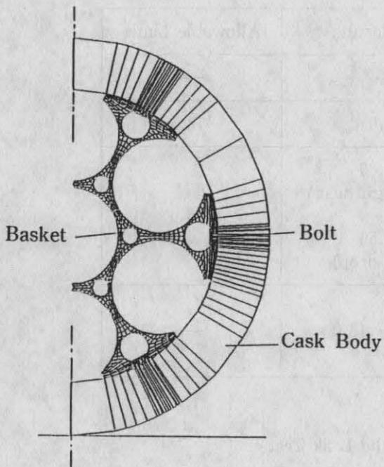
Fig. 4 Plane-Strain Model
